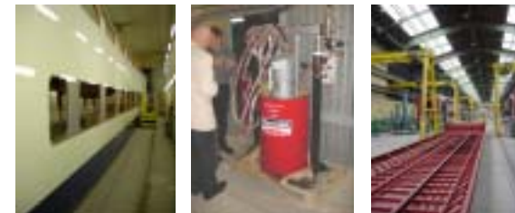
水性制振遮音剤施工車輦 水性制振遮音剤施工ガン 施工前床面
